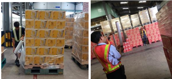
ภาพที่ 9 แสดงการพันพาเลทแบบเดิม(Hand Roll) และแบบใหม่(Film Dispenser #1)
