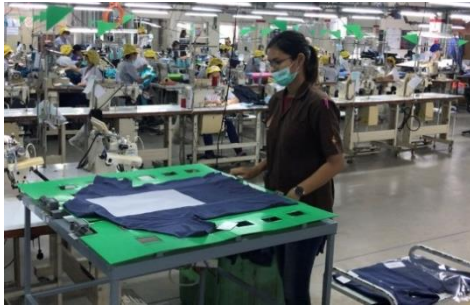
รูปที่ 4 วางเสื้อและกดปุ่ม Push Button เพื่อเริ่มทำงาน
